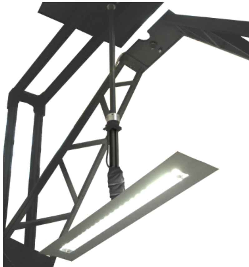
Abbildung 4.1.: Deckenleuchte (z.B. Bürobeleuchtung) im Nahfeldgoniometer
